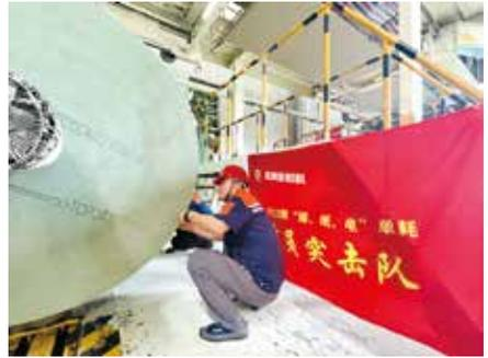
外包装后不影响正常使用的一律不予裁剪。减少护面纸纸筒剩余量，由原先的剩余50多米减少到15米左右。生产线在使用时发现护面纸有破损情况时，拍照留存并及时上报，经核实后再裁剪使用。
