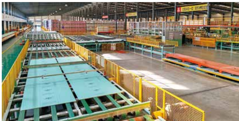
聊城公司石膏板生产线
